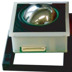
5. Trackball mit Rahmen in Tastatur einfügen und verschrauben
